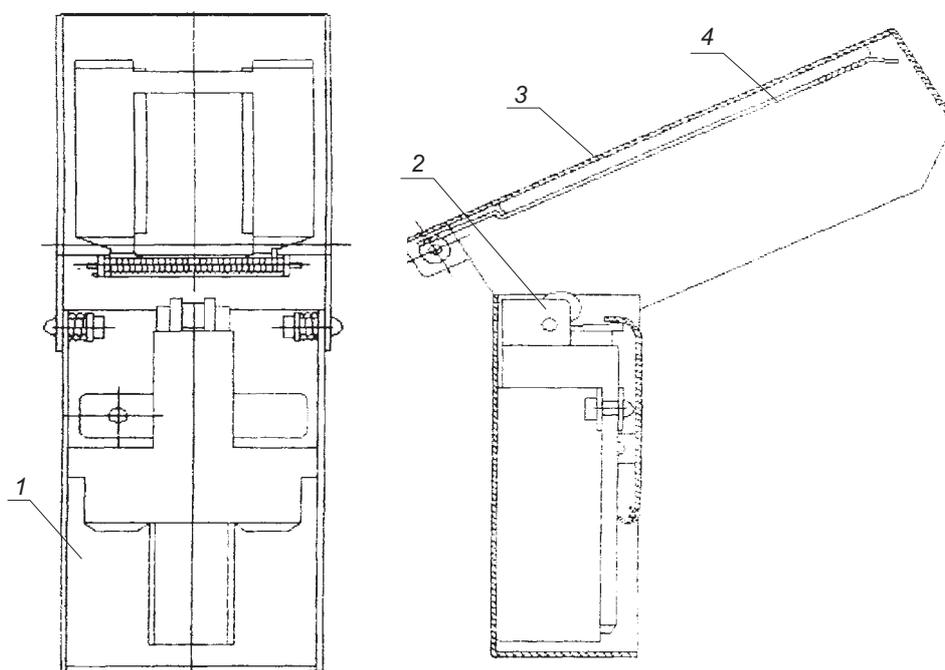
1 — корпус; 2 — газовая зажигалка; 3 — поворотная крышка; 4 — зажимное устройство
