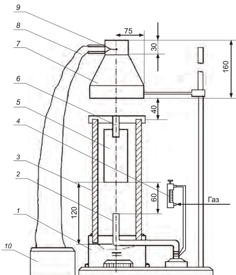
1 — подставка; 2 — газовая горелка; 3 — керамический короб; 4 — ротаметр; 5 — образец; 6 — держатель образца; 7 — зонт; 8 — термоэлектрический преобразователь; 9 — верхний патрубок зонты; 10 — автоматический потенциометр
